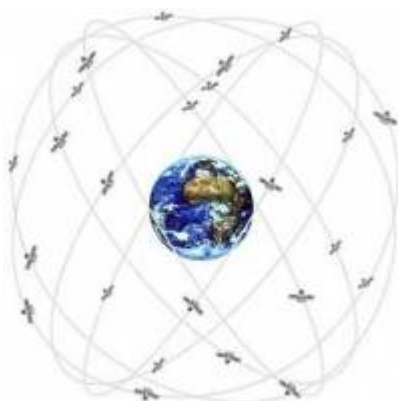
Abbildung 1: Umlaufbahnen der Satelliten http://www.kowoma.de/gps/orbits.jpg (Zugriff: 19.04.16)
