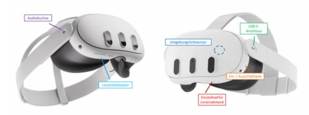
Abbildung 1: Aufbau des Headsets; eigene Darstellung verändert von links externe Verlinkung (10.10.2024) und rechts externe Verlinkung (10.10-2024)
