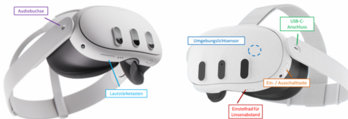
Abbildung 1: Aufbau des Headsets; eigene Darstellung verändert von links externe Verlinkung (10.10.2024) und rechts externe Verlinkung (10.10.2024)
